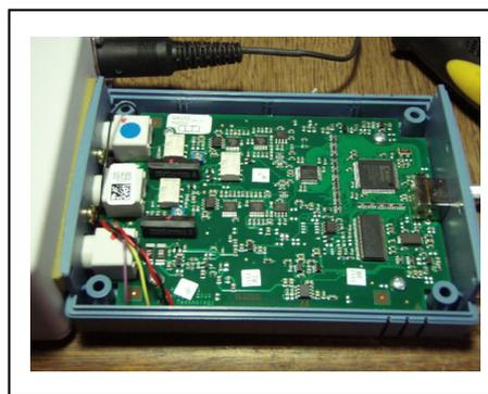
図4: 波形出力部回路
