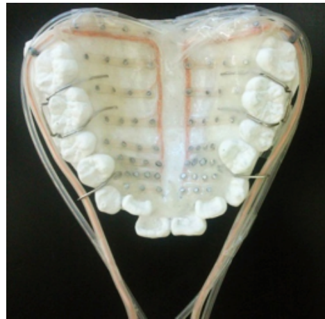
図 3. 口蓋部の舌接触センサー
