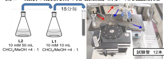
図2 溶液の混合方法の概略図(左)と用いた装置図(右)
