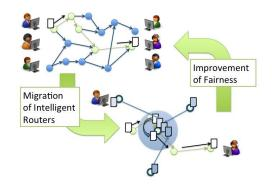
そこで、出発点として、パラボリックフェ アネスに基づく送信レート制御を, エンドツ ーエンドのユーザ端末と,複数の通信フロー の監視や制御を行うインテリジェントルー タとの連携によって分散的に実現する方式 を確立する. また, フェアネス指標(制御の 効果)の向上に、高度なヒューリスティクス とメタヒューリスティクスアルゴリズム[4] を適用する. それに基づき, 計算時間やイン テリジェントルータの配備等と制御の効果 とのトレードオフを柔軟に扱える枠組みの 確立を目指す. さらに、それによって様々な 時間粒度における制御の適切な組み合わせ も模索する. 同様に、フェアネス理論に基づ く経路制御についても検討する. フェアネス 理論に基づくトラヒック制御は、極端なアン バランスを未然に防ぐ能力を自ら備えてい ることが期待でき、それによって想定外の異 常なトラヒック状態が発生したときにも決 定的な破綻(カタストロフィ)を回避する堅 牢性が実現できる可能性があり、その調査も 行う.
