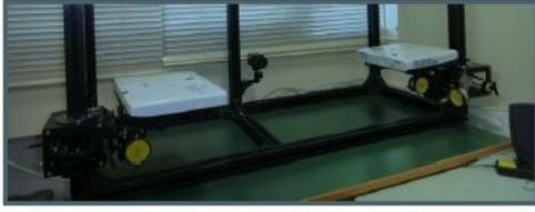
図3：2台のプロジェクタで時空間変調した照明光を照射（時間変調速度は液晶プロジェクタのフレームレートに制限される）。
