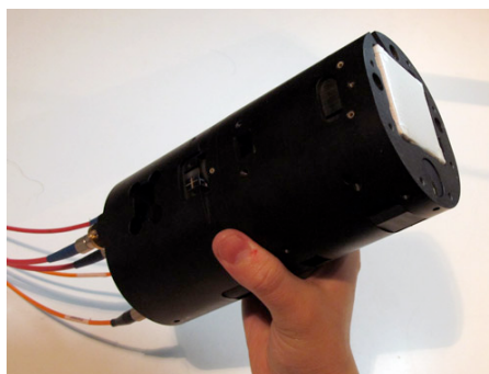
図 2 モジュール型 OPAM の外観。底面積 64 \text{ cm}^2 、高さ 19 \text{ cm} 程度の円筒型で、カリウムを封入した立方体ガラスセルを有す。
