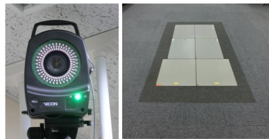
図2. 赤外線カメラと床反力計。
