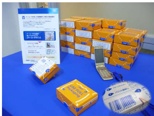
図8. 量産コストの増加を伴わない蝕知加工
