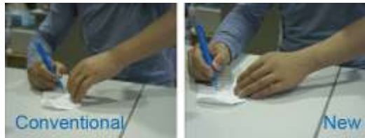
図5 ソフトソケットと指関節のバネ機構によって実現される義手の自然な動作
