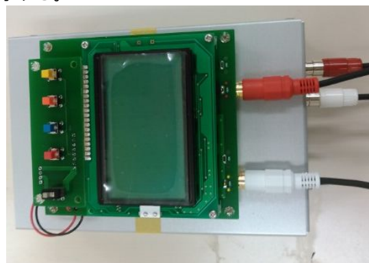
図4 デジタル部の基板（アナログ基板を入れたシャーシ上に乗せ、接続されている）
