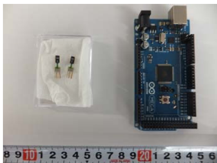
図5 温湿度センサーと制御基板（実験B）
