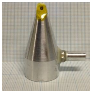
図5 内部排気可能な真空コリメーター
