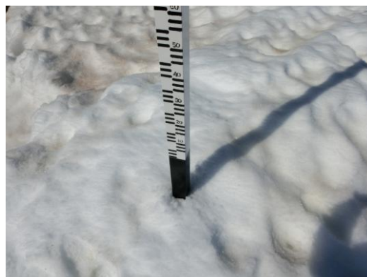
図 2. 無人観測システムの一部である、積雪深計測用ポール。
