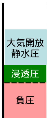
Fig.12 負圧が発生する必要条件
