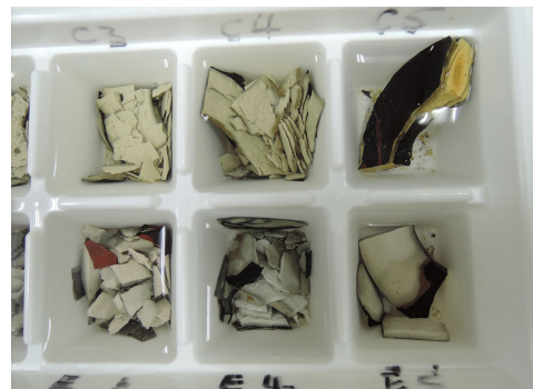
図2 冷解凍40回で崩壊する試験片
