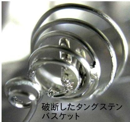
図2 合金化し破断したタングステン線
