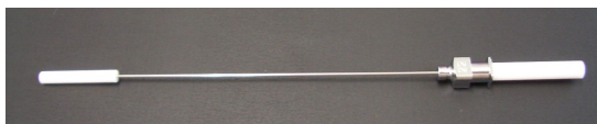
図2 試料前処理針のサンプリング後の保存方法。針の先端と根元部分にそれぞれフッ素樹脂製のキャップおよびプラグをつけることにより、数日程度まで常温保存が可能。
