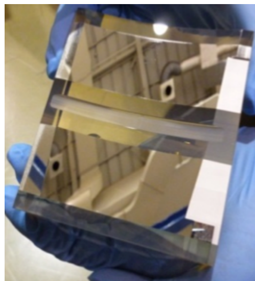
図 1 試作 Wolter ミラーの外観形状。
