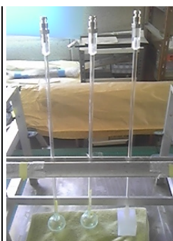
図2,液体キセノン容器 左:プラスチックシンチレータ 中央:TPB 入りプラスチックシンチレータ 右:TPB 蒸着アクリル
