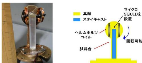
図 2 μSQUID - NMR 用に作製されたサンプル台 (右:概略、左:写真)
