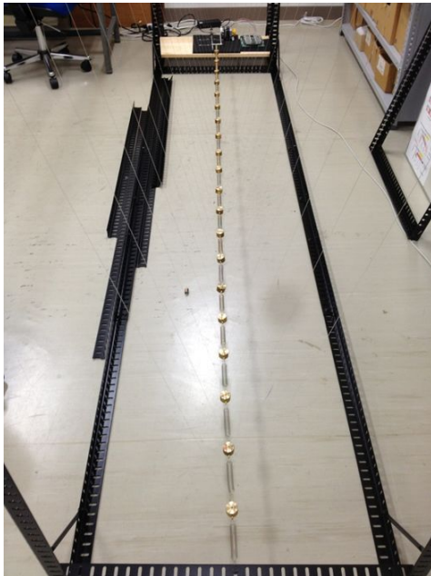
図2 作成した連成振動子列(錘20個)
