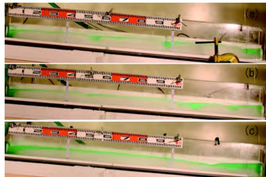
図 3 実験 2 で形成された氷上のステップの例. (a)CSIM-120908A, 代表波長 40cm, (b) CSIM120910B, 代表波長 60cm, (c) CSIM120911B, 代表波長 125cm.
