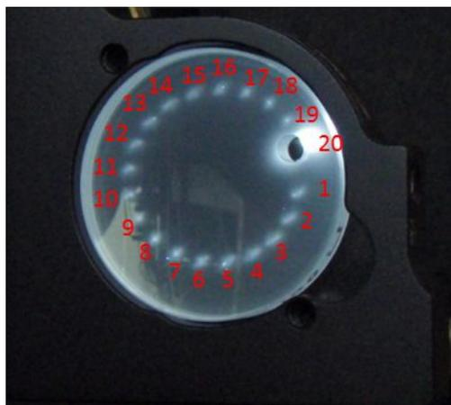
図 2 Herriott 型多重反射ミラー上のレーザースポット
