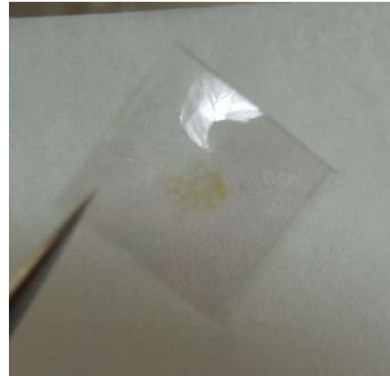
図 4. PET フィルムを用いて超音波印加により薄膜化した TTC 18 -TTF 薄膜。瞬間的・局所的な加熱のため、耐熱性の低いフィルム材料を基板に用いることも可能である。
