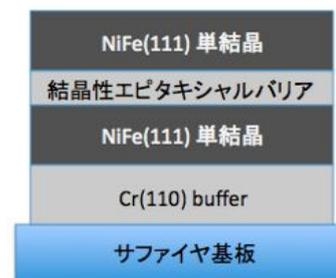
Fig.1. 強磁性トンネル接合試料の構造例。
