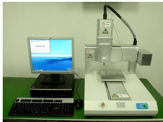
図1 開発導入した3D押し込み試験システム
