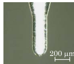
図2 マイクロ工具 図3 テンショナー (先端半径 100\mu\text{m} )
