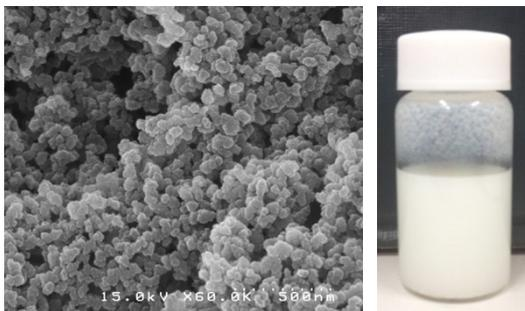
図7 Novec FC-4432 を用いて合成した Al<sub>2</sub>O<sub>3</sub> ナノ粒子の SEM 像と HFE-7200 ベース Al<sub>2</sub>O<sub>3</sub> ナノ流体の様態
