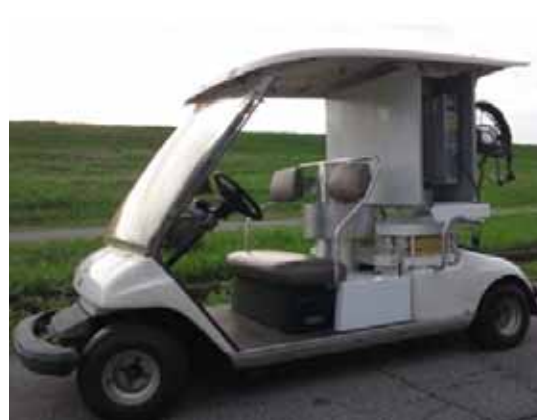
図1 磁気軸受型電力貯蔵フライホイール搭載電気自動車の概要
