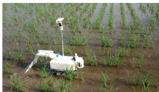
図4 田面改質ロボットによる水田の抑草
