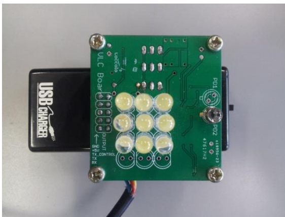
図 11 FSK 方式でスマートフォンと接続する VLC モジュール
