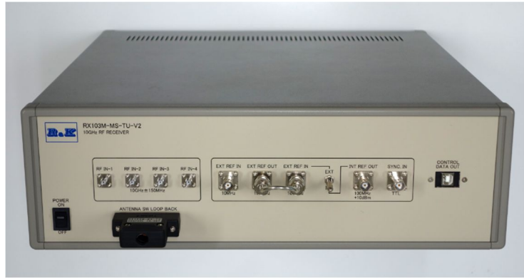
図 2 受信機ブロック図(上图)及び実際に製作した受信機(下图)。ブロック図の詳細については本文を参照。図 1 の送信機に用いたパッチアンテナと同一の受信アンテナを 4 本用意し、各アンテナに到達する送信波の時間差を、信号復調に用いる疑似ノイズ信号の重畳タイミング差、及び復調された信号の位相差より求める。求めた到達時間差から、送受信アンテナ間距離の相対差を知ること、受信アンテナの張る空間内に於ける送信アンテナの位置を算出する。今回製作した受信機は、1 つの受信回路を 4 本の受信アンテナで共有し、受信アンテナをサイクリックに切り替えながら時分割受信を行う。
