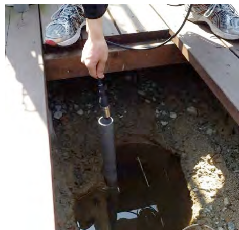
図5 水位センサーの雨水タンクへの投入
