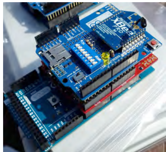
図6 16bit A/D 変換シールドを搭載した Arduino およびXBees シールドによる水位センサーノード
