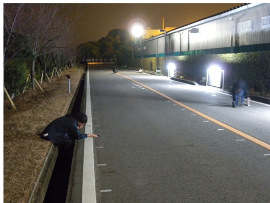
図 6 水平面照度測定の様子
