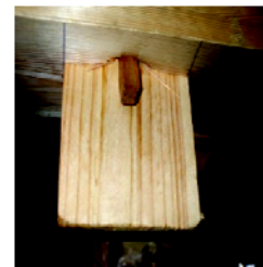
NPJ-K 写真2 破壊性状 (めり込み)
