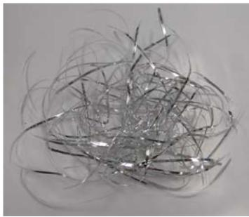
図3 Mg<sub>85</sub>Ca<sub>10</sub>Al<sub>5</sub>合金急冷薄帯の外観
