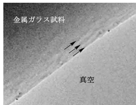
図 1 過冷却液体状態(573K 近傍)で現れる縞状コントラスト。縞の間隔は約 100nm である。
