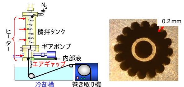
図1 中空系膜作製装置の概略図と加工口金
