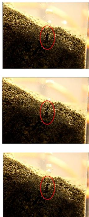
図7 細砂(大)からの気泡放出の様子
