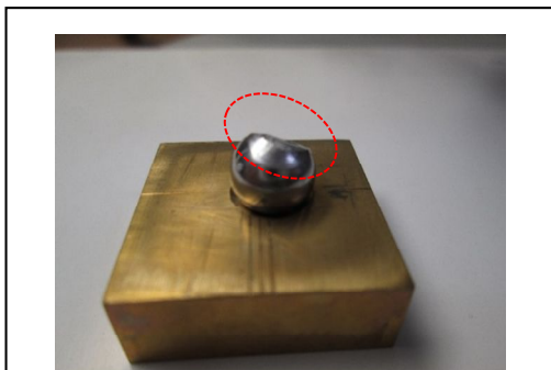
図4：回収されたステンレス製の飛翔型プローブの写真。図中点線で囲まれた場所が溶融していた。またダイバータ板上には溶融したステンレスが付着しており、双方の合計とプラズマに暴露する前の質量差から質量欠損が 5mg と算出された。
