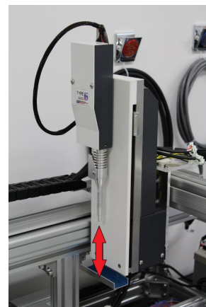
図1 2軸アクチュエータ上に固定された電動ピペッター 電動ピペッターをXY軸方向に平行移動、Z軸方向(図中赤矢印)に上下させることで、試料の吸入や吐出を自動
