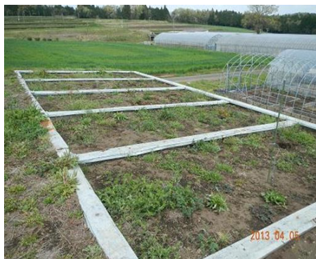
図 1. ライシメーターに充填し、製鋼スラグを混入して 1 年間放置した土壌の様子。
