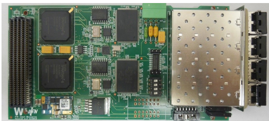
図 4：設計製作した最終版の 12 層基板回路
