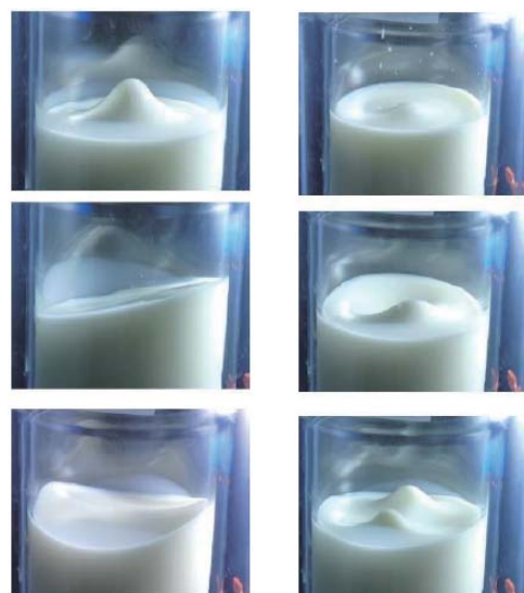
図2 縦加振による様々な液面変形モード (可視化のため牛乳を用いた場合)
