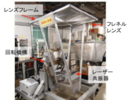
図 2-3. 太陽光集光システム試作機
