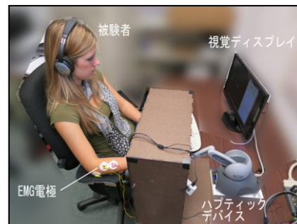
図8：遅延環境における運動推定に基づく力覚提示システムの様子
