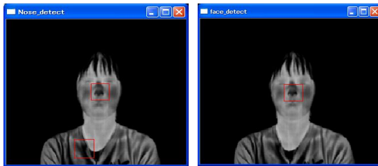
(a) 従来法 (b) 提案手法 図2 鼻部領域の検出結果の比較
