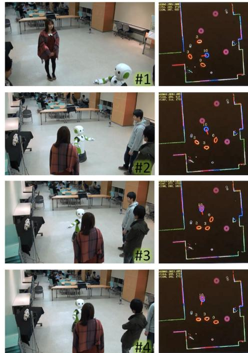
図6 複数人物追跡結果のミュージアムガイドロボットへの応用
