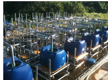
写真1. 濁水と掃流砂の濃度および流速の違いが付着藻類に及ぼす影響を検証可能な循環型水路
