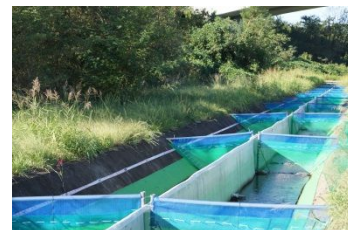
写真3. 条件を変えた付着藻類を沈水させ、流水環境で魚類を飼育可能な実験河川
