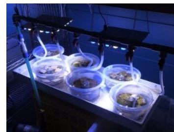
写真2. 条件を変えた付着藻類を沈水させ、流水環境で水生昆虫を飼育可能なメソコズム
