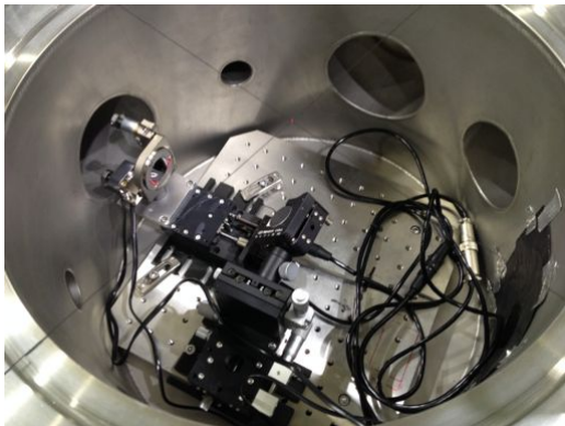
図 1 : 軟 X 線照射装置(a)外観と(b)真空容器内の軟 X 線光学素子配置
